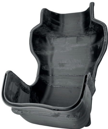
Maßarbeit ohne Formwerkzeug: Dieser Rennschalensitz wurde im beschriebenen 3D-Druck-Verfahren hergestellt © IWU
